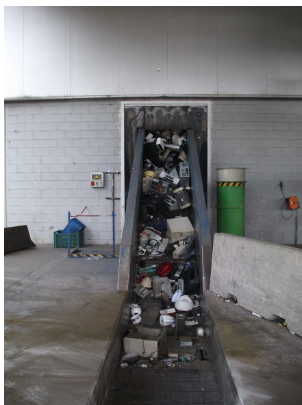
Imagen 2: Entrada de RAEE a la línea de pretratamiento (Electrorecycling).
