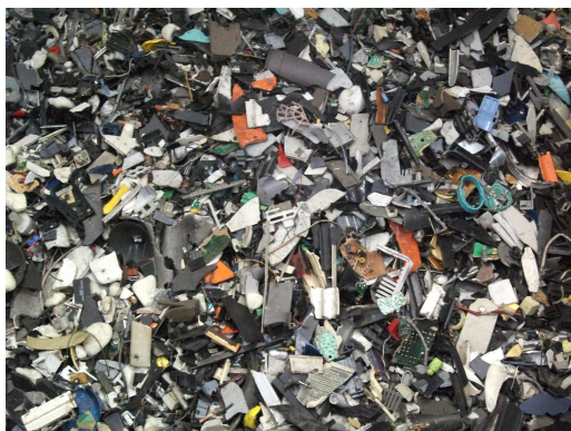
Imagen 4: Ejemplo de una de las fracciones de material de salida de la fragmentadora en el centro de valorización de RAEE de Electrorecycling.
